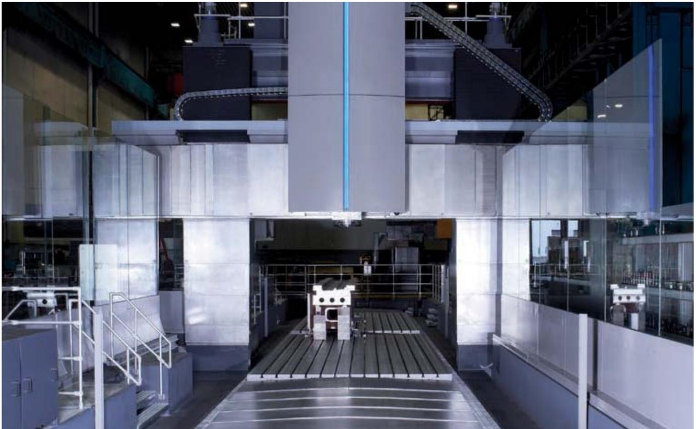
Um zu verhindern, dass sich Kühlschmiermittel und Hydrostatiköl vermischen, werden die Maschinenachsen mit Teleskopabdeckungen abgedichtet. Zusätzlich zu den regulären Abdichtungen sind die Rückwände und Gleiter der Ständerabdeckungen als Sonderkonstruktion ausgeführt, um die Kühlflüssigkeit direkt abzuführen.
